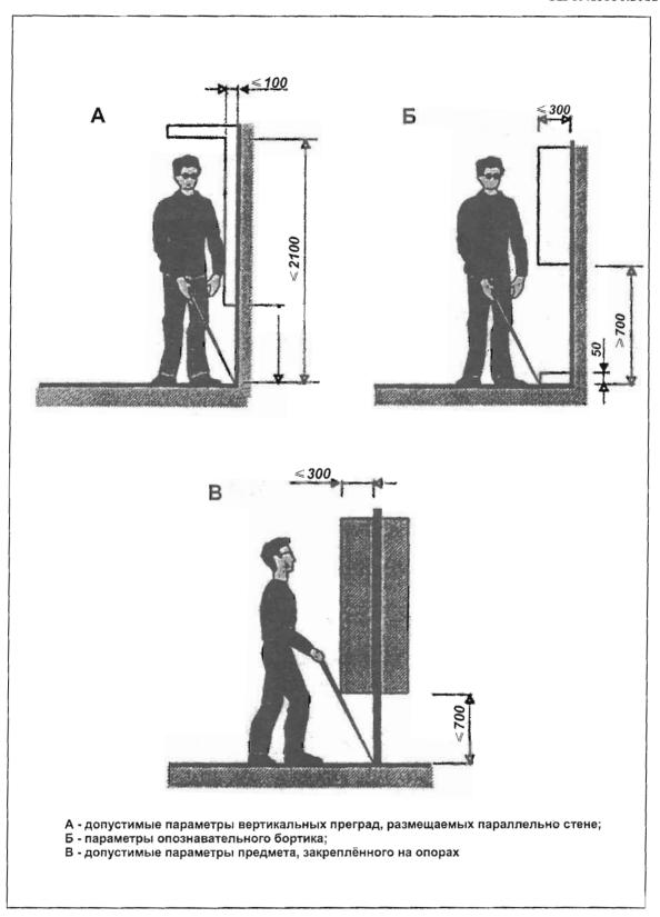
Рисунок Д.4 - Оптимальные габариты полосы движения
