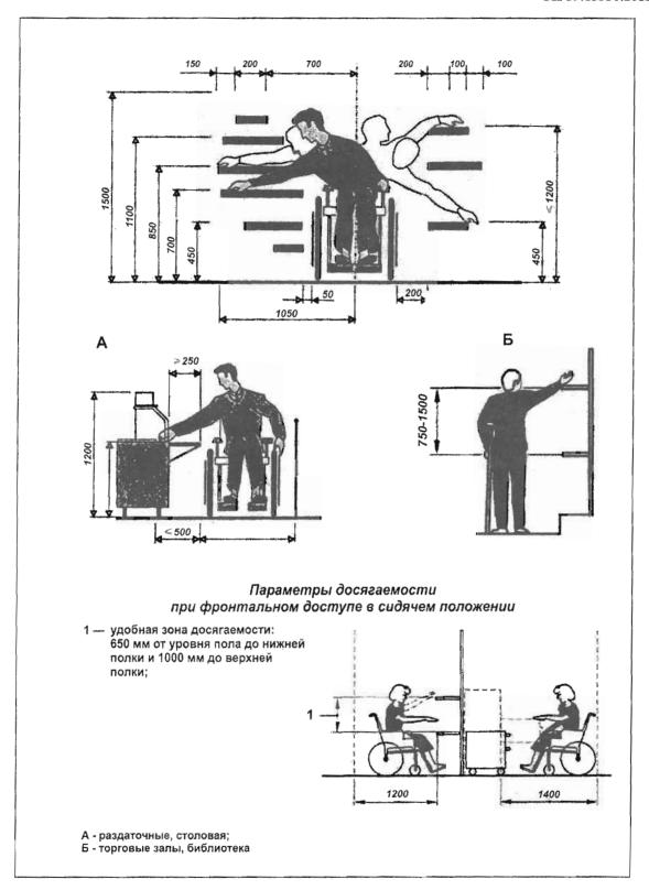
Рисунок Д.2 – Зоны досягаемости и эргономические параметры
