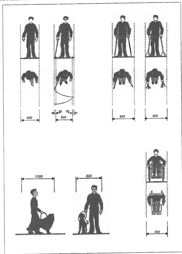
Рисунок Д.З. - Оптимальные габариты полосы движения
